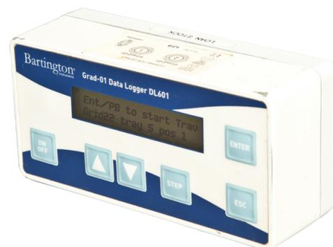
DL601 数据记录仪在调查(survey)模式期间，运用高速采样速率测量磁场梯度，具有自动平均每个读数的功能。采样速率可根据操作者的节奏(pace)进行调整。
