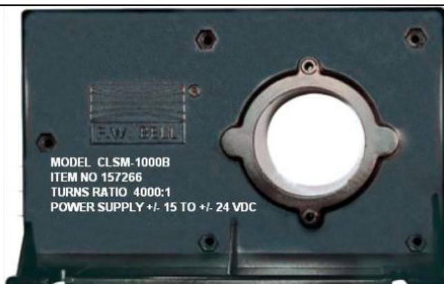
型号CLSM-1000B是闭环霍尔电流传感器，精确测量直流和交流的电流，并提供被测电流或电压和输出信号之间的电气隔离。
