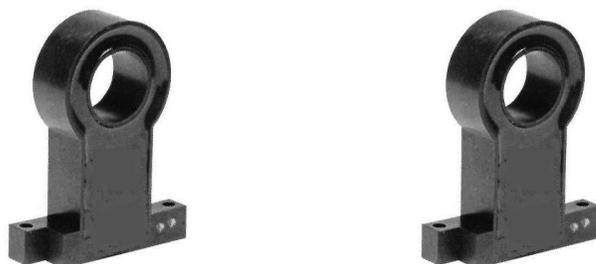
NL系列漏电流传感器是最新推出的高可靠性传感器，可以精确测量微小的直流电流，并提供被测电流和输出信号之间的电气隔离。这种改良的漏电流传感器体积小，可靠性高，适合长期工作状况，使用方便，不影响被测线路，最小可测电流为10微安培(10uA)，最适合测微安和毫安级的微弱电流，用处广泛，性价比极高。另一个突出的优点是峰值电流超量程后不会损坏传感器。
