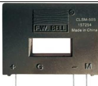
型号CLSM-50S是闭环霍尔电流传感器，精确测量直流和交流的电流，并提供被测电流或电压和输出信号之间的电气隔离。
