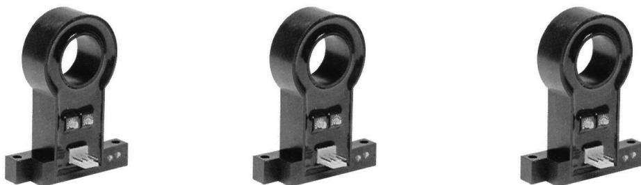
NP通用型交直流电流变送器（4-20mA输出），可以精确测量交流电和直流电，输出和被测电流有效值成比例的4-20mA。并提供被测电流和输出信号之间的电气隔离。其用处广泛，性价比极高。NP通用型交直流电流变送器只需要单路24VDC或220VAC供电。另一个突出的优点是峰值电流超量程后不会损坏传感器。
