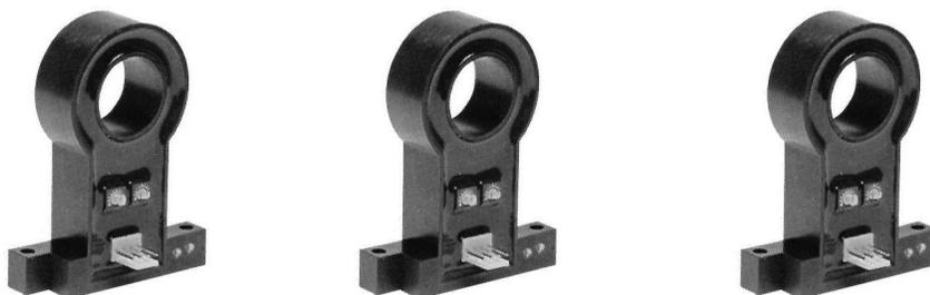
NC2系列高精度霍尔电流传感器可以精确测量交流电和直流电，线性度可以达到0.1%，并提供被测电流和输出信号之间的电气隔离。另一个突出的优点是峰值电流超量程后不会损坏传感器。
