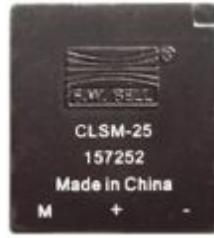
型号CLSM-25是闭环霍尔电流传感器，精确测量直流和交流的电流，并提供被测电流或电压和输出信号之间的电气隔离。
