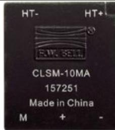
型号CLSM-5MA和CLSM-10MA是闭环霍尔电流/电压传感器，精确测量直流和交流的电流或者电压，并提供被测电流或电压和输出信号之间的电气隔离。
