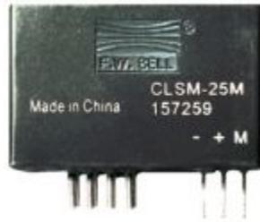
型号CLSM-25M是闭环霍尔电流传感器，精确测量直流和交流的电流，并提供被测电流或电压和输出信号之间的电气隔离。
