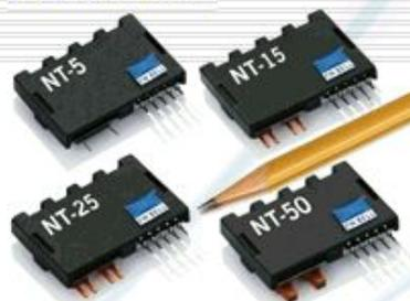
NT系列超薄型电流传感器是世界上最轻最薄的电流传感器，可以精确测量交流电和直流电，精度可以达到0.3%，并提供被测电流和输出信号之间的电气隔离。NT系列电流传感器精度高，响应快，交直流通用。它采用厚膜集成工艺制造，体积小，重量轻，可直接安装在印刷线路板上。
