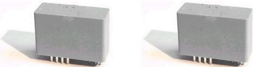
NC1系列高精度霍尔电流传感器可以精确测量交流电和直流电，线性度可以达到0.1%，并提供被测电流和输出信号之间的电气隔离。NC1系列高精度霍尔电流传感器体积小，重量轻，独特的设计使得它们允许被直接安装在再线路板上。通过不同的管脚连接方式，可以得到不同的量程。另一个突出的优点是峰值电流超量程后不会损坏传感器。
