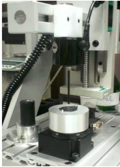
接触感应器， 在测试中接触被测物体时会 自动调节
